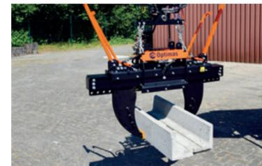
La pinza para piezas Multiflex es apropiada para la colocación de bordillos de hormigón y de granito, rigolas, peldaños y diversas baldosas. Mediante el intercambio de las mordazas de apriete (opcional) se obtienen muchas posibilidades de aplicación, como p.e. colocación de palisadas, piezas en L, piedra natural, celosía de césped, piezas de paisajismo y muchas más.
