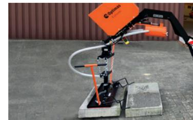
Con el aparato por vacío, el operario de la máquina de colocación puede recoger el solo las piezas de hormigón o de piedra natural directamente desde el paquete y depositarlas en la ubicación deseada. Mediante el montaje de las distintas ventosas, el aparato se puede utilizar para el montaje de distintos elementos como p.e. baldosas, bordillos etc.
