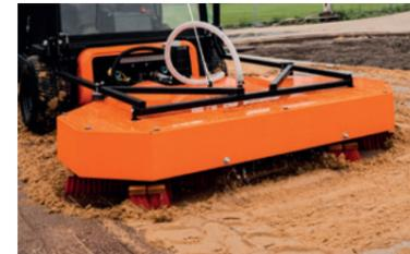
El aparato para el relleno de juntas en adoquines OPTIMAS para su acoplamiento en la máquina de colocación es ideal para barrer el material de relleno en las juntas en obras de tamaño mediano y grande. Debido a su extrema maniobrabilidad se puede introducir el material de relleno de forma exacta en las juntas, incluso en curvas y bordes.
