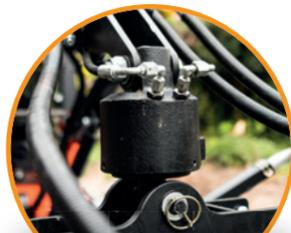
Cabeza giratoria hidráulica en la pinza 300°
