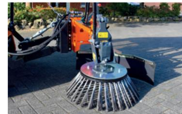
Con el cepillo de accionamiento hidráulico para la eliminación de las malas hierbas, puede quitar cualquier tipo de hierba sin esfuerzo y sin productos químicos. Como accesorio para la máquina de colocación de adoquines, el cepillo para la eliminación de malas hierbas representa un sistema de limpieza óptimo para la eliminación de suciedad persistente incluso en zonas de bordes.
