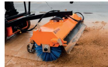
La barredora se montada de forma fácil y rápida en el eje delantero. Basculación mecánica de 20° de forma sencilla hacia la izquierda y derecha. En caso necesario, se puede recoger al mismo tiempo el material barrido en un depósito (opcional). Ideal para barrer (limpiar) obras y patios.
